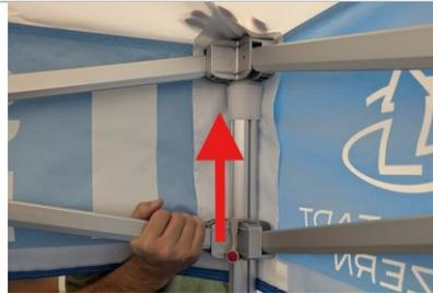
Dachblende mittig herunterziehen und mittels Klett befestigen.
